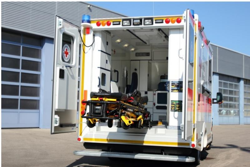
Auf die 750 kg-Ladebordwand am Fahrzeugheck kann der Prototyp des S-RTW BY 2013 so komplett verzichten, was das Fahrzeugkonzept näher an die Standard-RTW in Bayern rückt. Nicht zuletzt kommt dies dem Grundgedanken, die S-RTW in einer Mehrrollenfunktion nicht nur für den Schwerlast-Einsatz bei Patientengewichten von bis zu 300 kg Körpergewicht, sondern auch als Reserve-Rettungswagen einzusetzen, entgegen.
